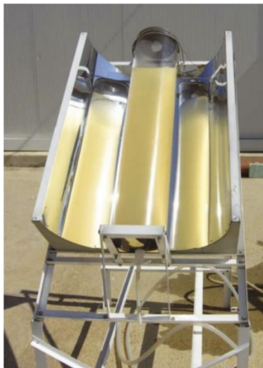
Abbildung 8: Reaktor zur solare Desinfektion (SODIS) (18)
