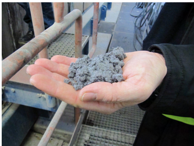
Abbildung 2.6: Entwässertes Klärschlamm aus der Altpapierrecyclinganlage
