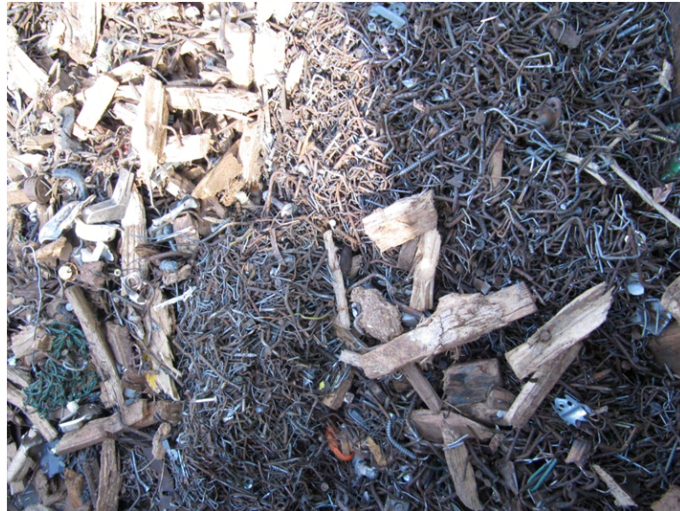
Abbildung 2.24: Rückstände aus der Eisenabscheidung der Brennstoffaufbereitungsanlage der Biomasseanlage Timelkam
