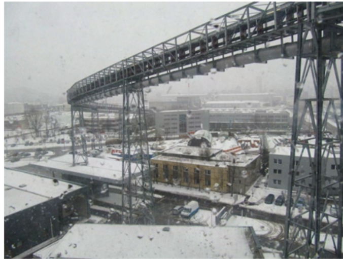
Abbildung 2.14: Rohrgurtt Förderer. Bild aufgenommen bei der Anlagenbesichtigung 2012
