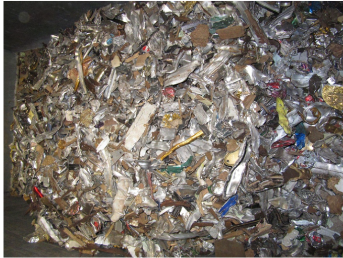
Abbildung 2.22: Rückstände aus der Nichteisenabscheidung aus der Brennstoffaufbereitungsanlage der Biomasseanlage Timelkam.
